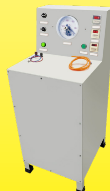
Kontrolle der Luftschalter-Betriebszyklen
