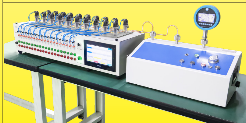
Überprüfung der Druckschalterkalibrierung
